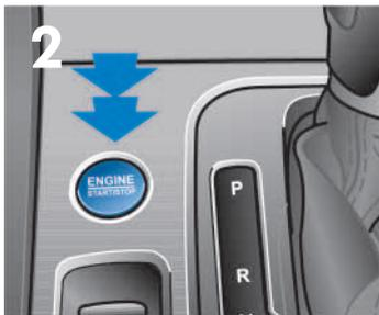
2. Start/Stop-Knopf bis zur zweiten Stufe durchdrücken
