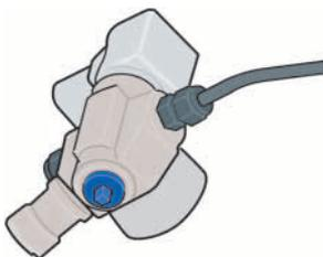
manueller Absperrhahn am Fuß des Flaschenventils.
