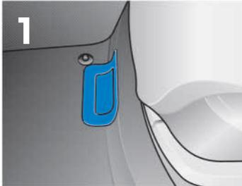
**1. Zugang zur Masseverbindung der 12V-Batterie lokalisieren.**
