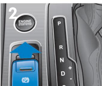
**2. Elektrische Feststellbremse betätigen**
