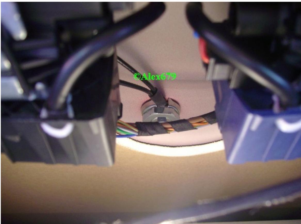
Die Steckverbinder für Navi/GSM ausklipsen.
