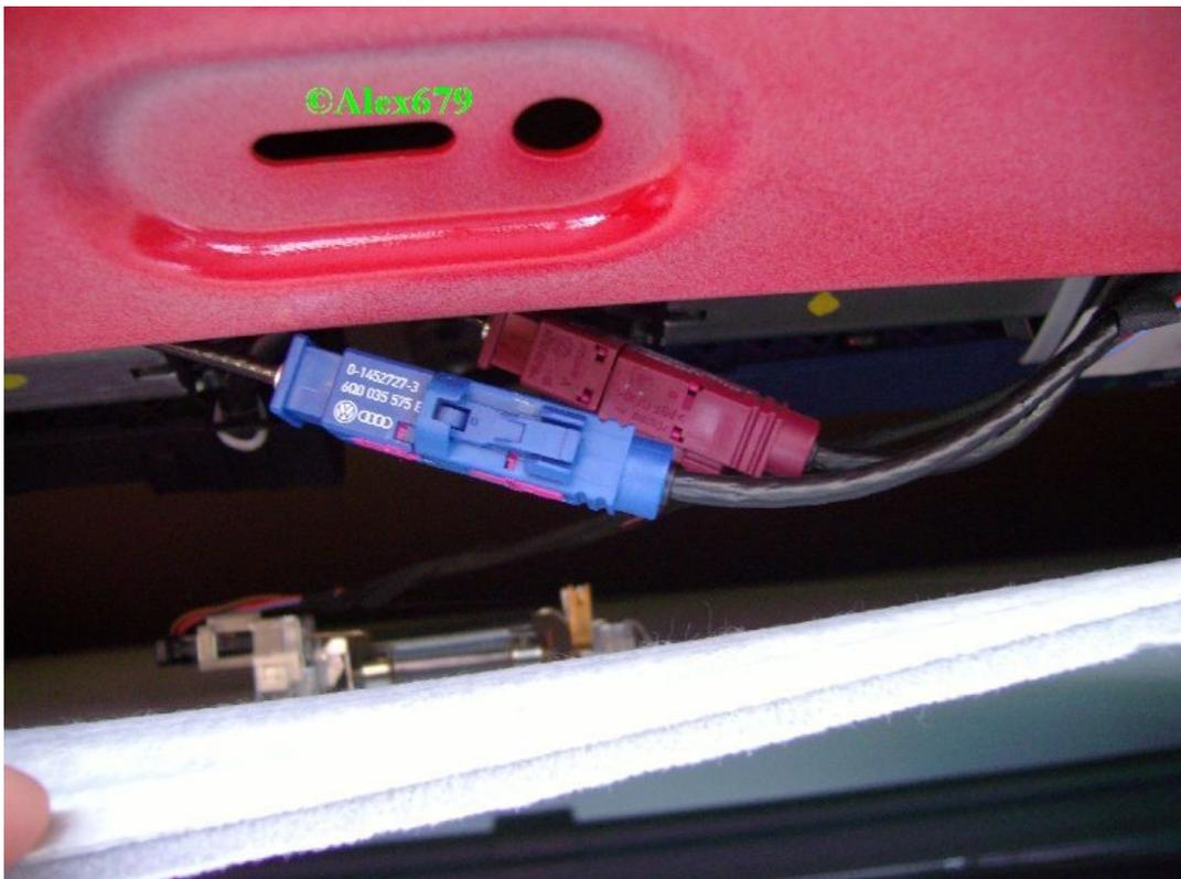
Kofferraumbeleuchtung ausclipsen, da man sich sonst unnötig den Arm zerkratzt beim schrauben.
