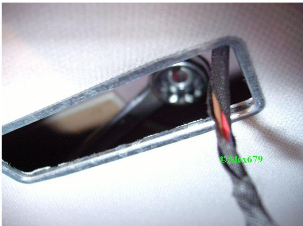
... wie man den 22 Ringschlüssel ansetzt und ob die Mutter beim Zusammenbau gerade "drauf sitzt".
