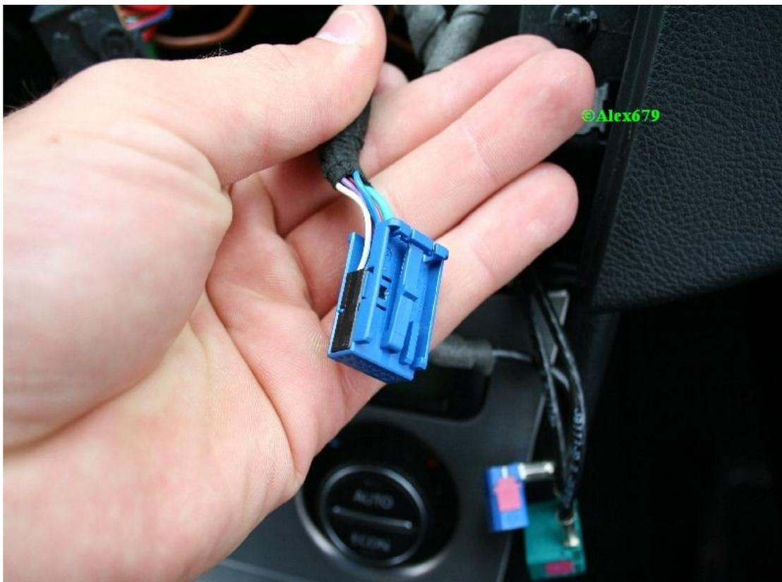
Jetzt wird das grüne Kabel, welches auf Pin 2 eingesteckt ist, ausgestoßen und dann auf Pin 3 eingesteckt.
