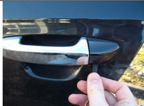
Bei geöffneter Tür die kleine Gummikappe entfernen. Türgriff nach außen ziehen und dabei vorsichtig die Schraube hinter der Gummikappe herausdrehen, bis der Türgriff von selbst draußen bleibt.
