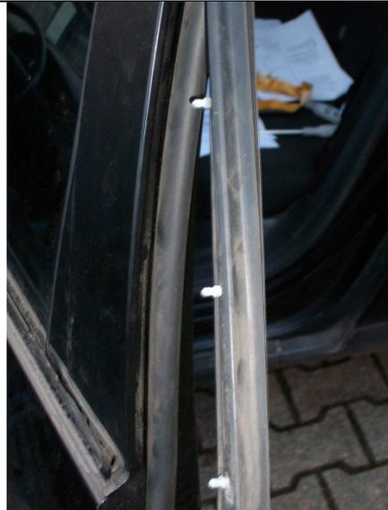
Innere Fensterdichtung nach oben herausziehen und die zwei dahinterliegende Schrauben herausdrehen. Nun das Abdeckblech nach vorne und nach hinten abziehen.
