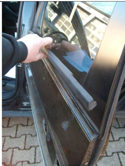
Äußere Türdichtung herausziehen. Ist wie auf dem Bild zu sehen nur geclipst.
